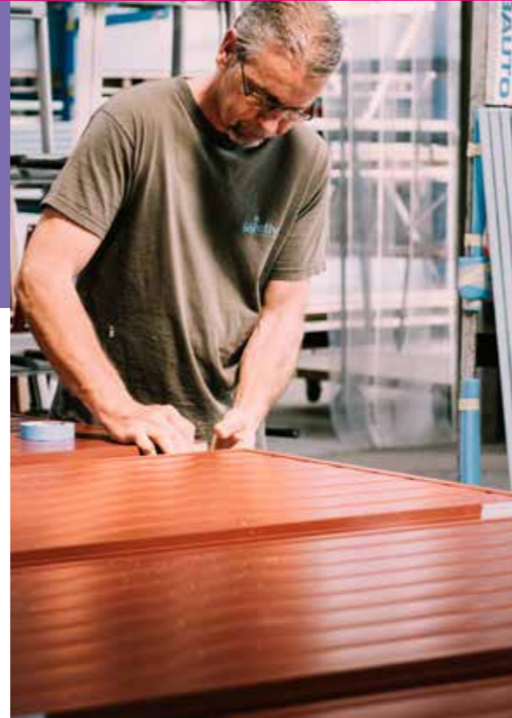
Travail de précision : le collage de U de coiffage.
